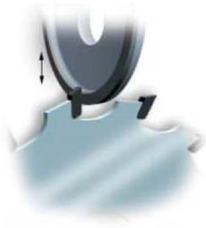
Rectification de la face de coupe
