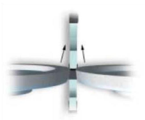
Rectification des flancs de scies
