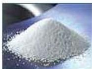
Le corindon est un oxyde d'aluminium ( $Al_2O_3$ ) et se subdivise selon sa pureté en corindon ordinaire, semi-friable et supérieur.
