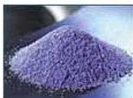
Cette structure à cristaux fins permet, lorsque croît l'usure des grains, de ne briser que les particules de petite taille. De cette façon, le grain est utilisé de façon optimale.
